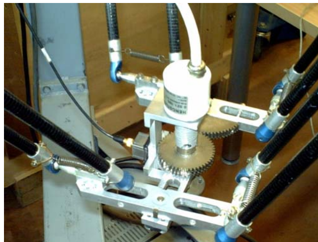
Figure B. Détail de la nacelle et son mécanisme d'amplification
