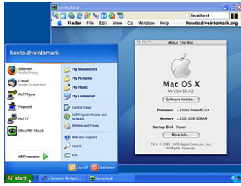
Figure 1: Un bureau MS Windows contenant un bureau MacOS via VNC. MacOS ne s'exécute pas sur la même machine que MS Windows, mais l'affichage du bureau MacOS est reproduit dans une fenêtre de MS Windows.
