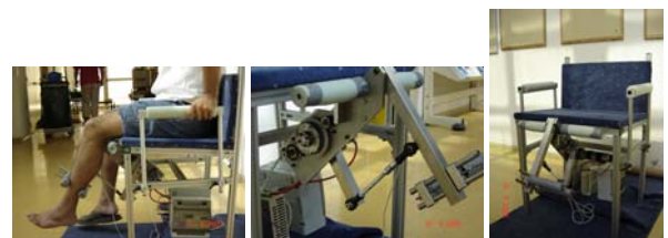
Figure 4 : chaise de mesure pour l'articulation du genou.
