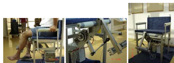
Figure 4 : chaise de mesure pour l'articulation du genou.
