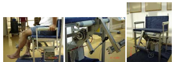
Figure 4 : chaise de mesure pour l'articulation du genou.
