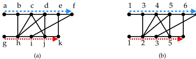
FIG. 1 – (a) une instance  $(G, R, P)$  de min-DAWN-paths avec 2 requêtes  $r_1 = (A, F)$ ,  $r_2 = (G, K)$ ,  $P(r_1) = (A, B, C, D, E, F)$  et  $P(r_2) = (G, H, I, J, K)$ . La figure (b) montre une assignation de dates correcte, sans conflit et minimum. Sur cette instance, l'approche gloutonne consistant à privilégier la requête dont la destination est la plus loin à atteindre, ne donne pas une solution optimale.
