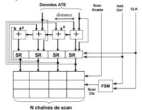
Figure 2: Architecture du décompresseur, N=4 et M=2
