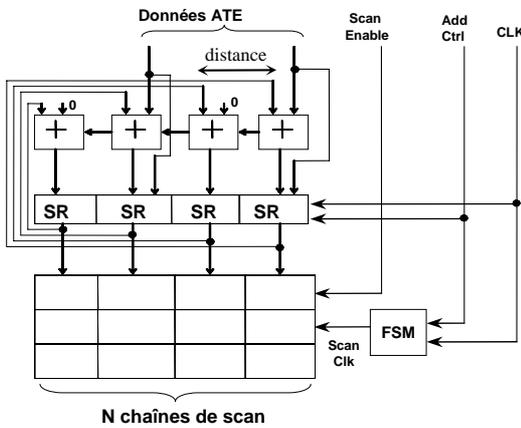
Figure 2: Architecture du décompresseur, N=4 et M=2
