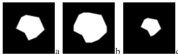
Figure 1 : image binaire (a) dilatée (b) et érodée (c).
