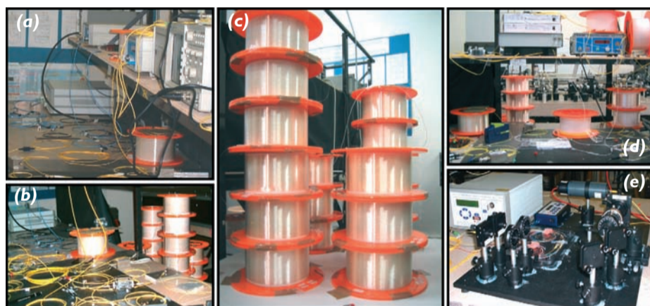
Figure 13 : Photos du dispositif expérimental (a) Générateur d'impulsions à 160-GHz (b) (c) et (d) Boucle à recirculation des solitons à respiration (e) Détecteur à autocorrélation.
