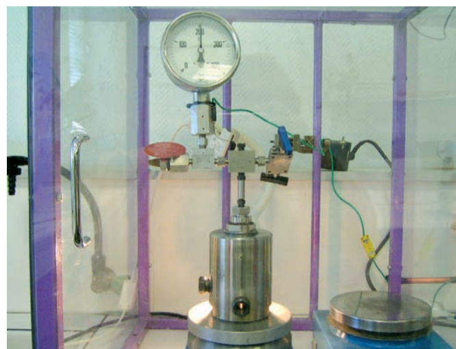
Autoclave à fenêtres en saphir pour l'étude des réactions en milieu supercritique
