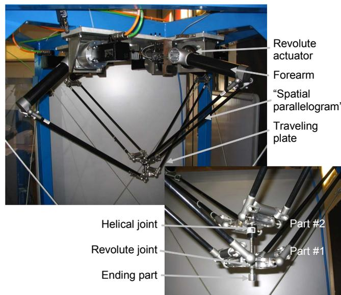
**Figure 13. Heli4 prototype.**
