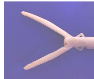
Figure 7. Mors d'un instrument de chirurgie moulés en polyuréthane.
