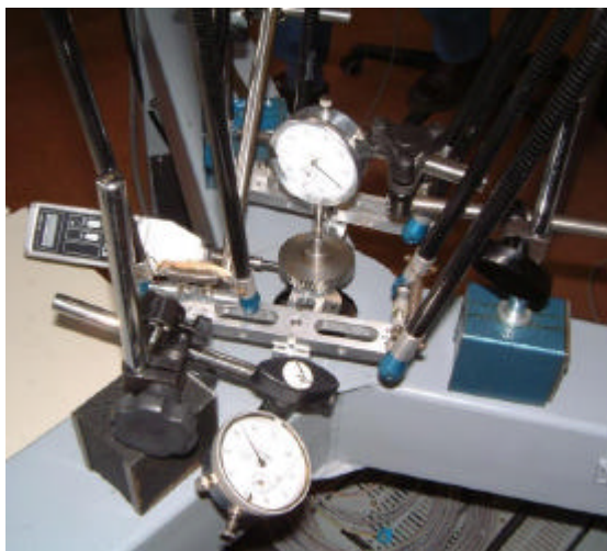
Figure 8. Mesures de déformations
