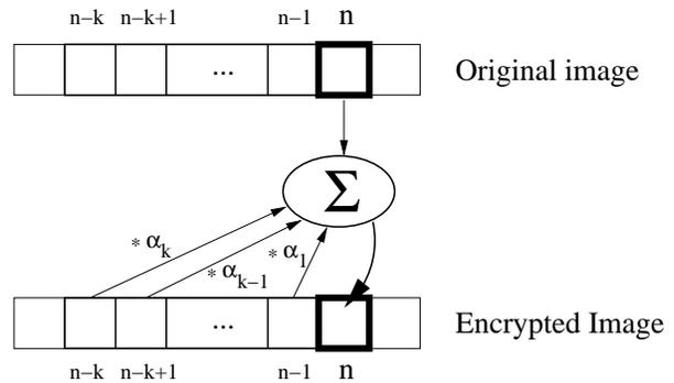
Figure 2 – Chiffrement d’un pixel par flux.
