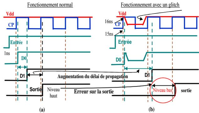
Figure 4 : Simulation d'un glitch négatif sur Vdd
