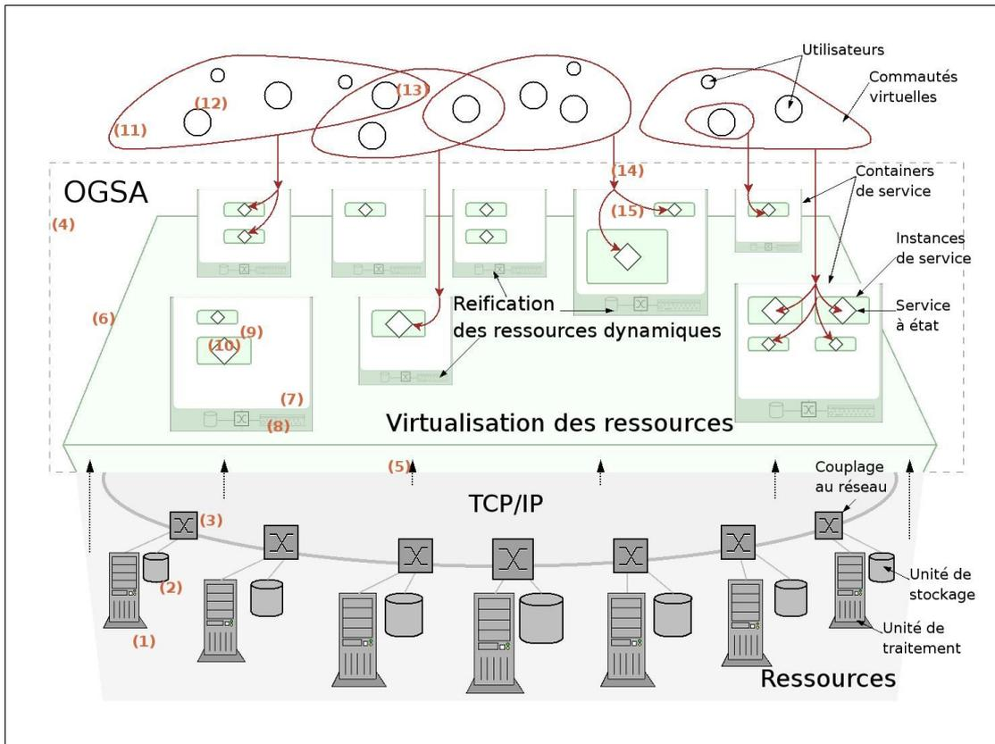
**Figure 2:** Ce modèle OGSA simplifié décrit un ensemble d'unités de ressource couplées par un réseau TCP/IP. Cet ensemble ainsi virtualisé fournit une capacité de traitement et de stockage globale. Les services sont ensuite instanciés dans des conteneurs dynamiques sur une portion de ressource réifiée.
