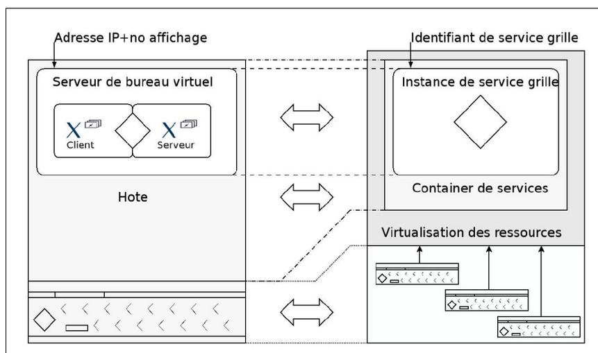
**Figure 6:** Une architecture orientée système (à gauche) est caractérisée par un hôte unique accessible par une adresse IP, tandis qu'une architecture orientée services (à droite) est équivalente à un ensemble de ressources virtualisées au sein de laquelle peuvent s'exécuter des instances de service accessibles par un identifiant unique.
