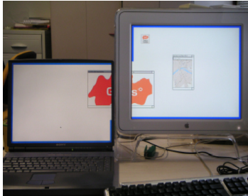
Figure 3: Avec le système I-AM, la fenêtre d'une application s'exécutant sur une machine A peut être affichée en partie sur le dispositif d'affichage de la machine A et en partie sur le dispositif d'affichage d'une machine B, les machines A et B étant reliées via un réseau. Il est bien sûr également possible d'afficher cette fenêtre uniquement sur un des deux dispositifs d'affichage [7].
