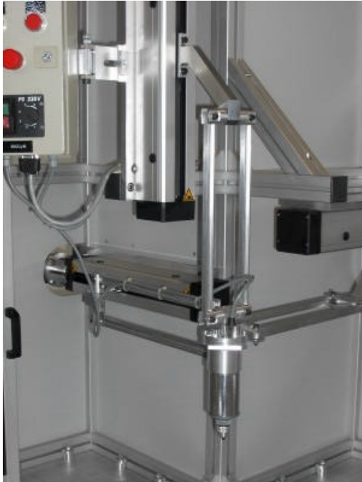
Figure 2. Le premier prototype d'Orthoglide.
