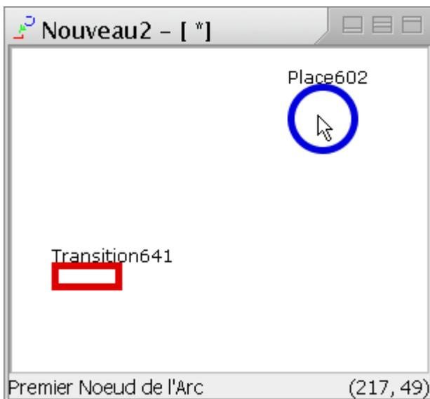
Puis sur le deuxième (ici une Transition) pour créer l'Arc Simple, en relâchant le bouton entre les deux clics. Si entre-temps vous appuyez sur une portion vierge du réseau, la création de l'Arc est automatiquement annulée.
