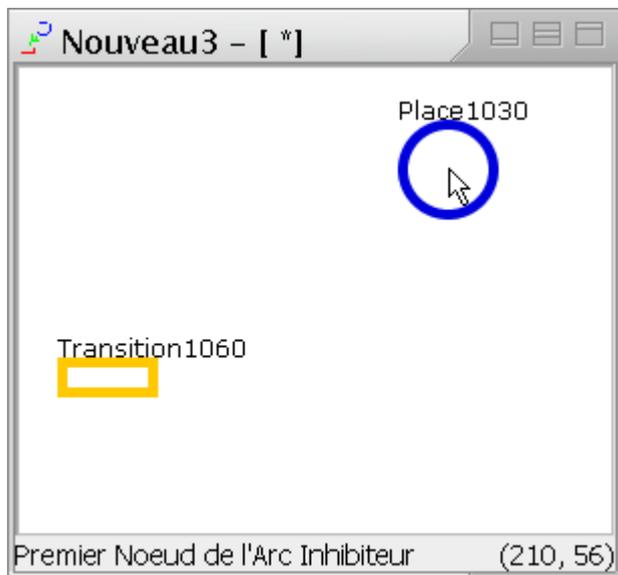
Puis sur la Transition pour créer l'Arc Inhibiteur.
