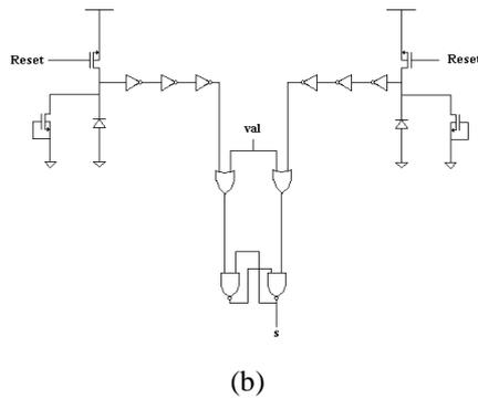
Figure 4 : Schémas des comparateurs (a) et (b) avec 2 photodiodes
