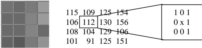
Figure 1 : Une image, ses niveaux de gris et le codage du pixel "112"
