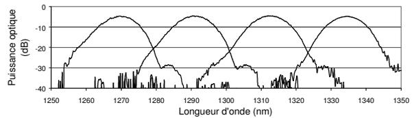
Figure 2 : Spectre mesuré sur un CWDM réalisé.
