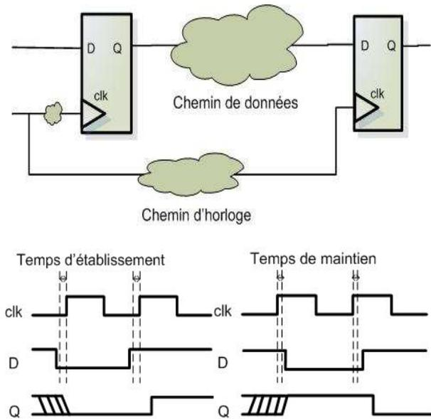
Figure 1. Illustration de temps d'établissement et temps de maintien respectés sur un chemin logique
