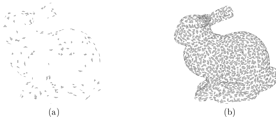
FIG. 14 – Sélection des quadrangles retenus sur le modèle bunny (8146 points, 16301 triangles) avec un seuil S_c de 0.1 : a) 150 quadrangles retenus avec la méthode ACM, b) 1491 quadrangles retenus avec la méthode par projection.
