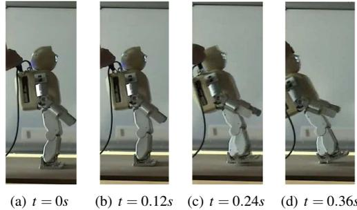
FIG. 5 – Mouvement optimisé en considérant 10 instants de discrétisation
