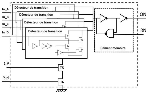
Fig.4: Capteur à 4 entrées.
