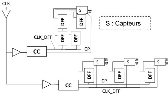
Fig 7: Exemple d'arbre d'horloge instrumenté du système proposé
