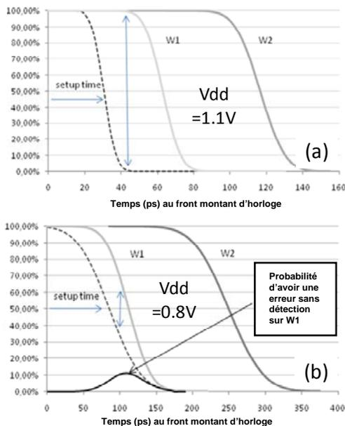
Fig.9. Efficacité du système de surveillance
