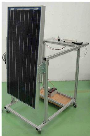
Fig. 14 : Panneau photovoltaïque inclinable de l'IUT de Nîmes
