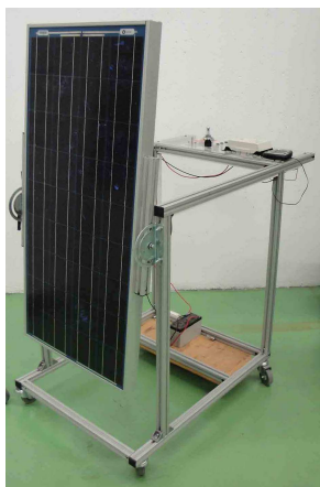
Fig. 14 : Panneau photovoltaïque inclinable de l'IUT de Nîmes
