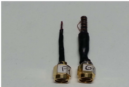
Fig. 5. The two EM injection probes
