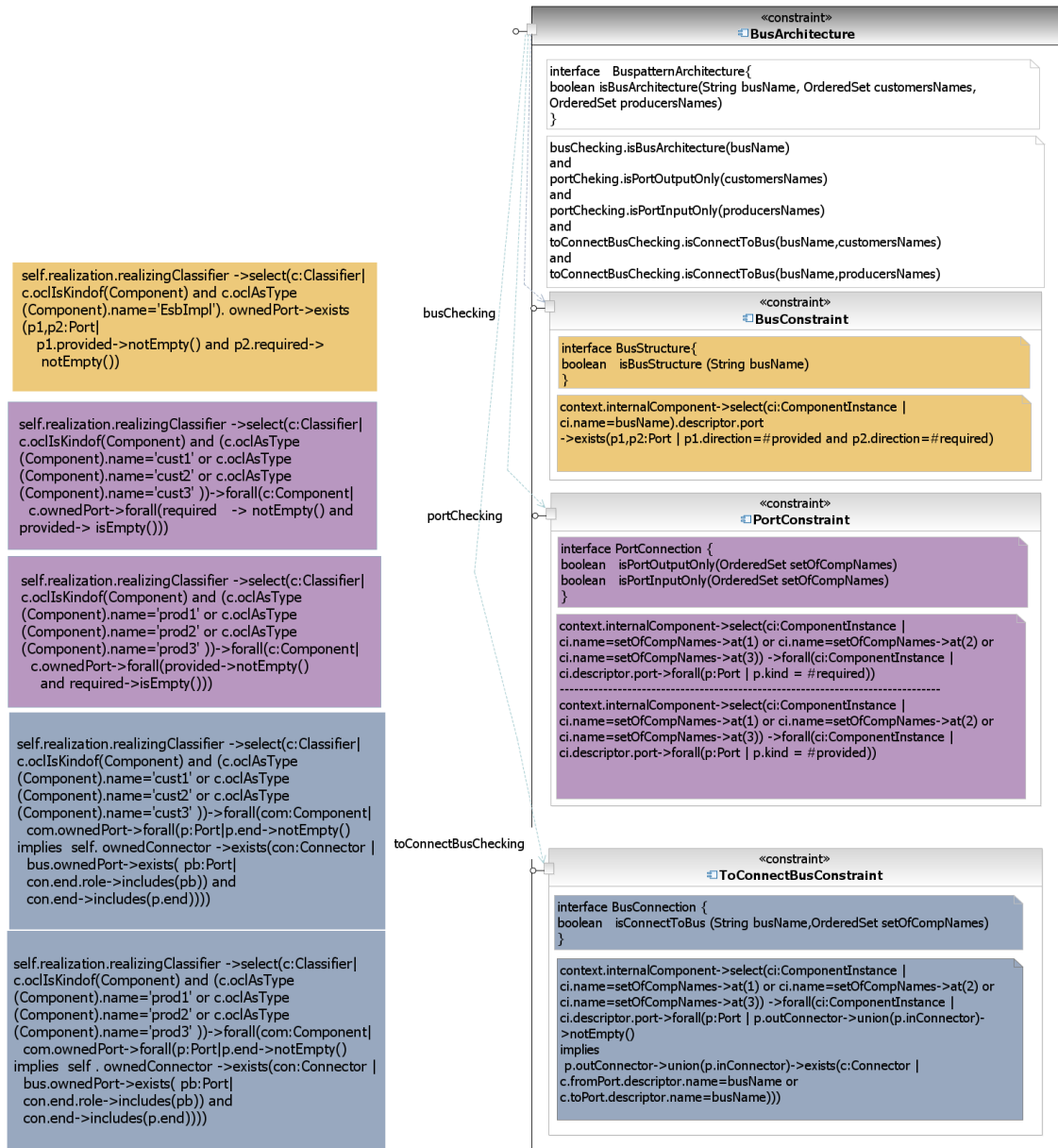
Figure 4: Composants-contraintes pour l'architecture en bus
