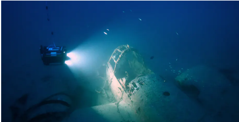
Epave d'avion inspecté par le robot sous-marin Basile du DRASSM. DRASSM, D. Dégez / V. Creuze, 2019, Author provided (No reuse)
