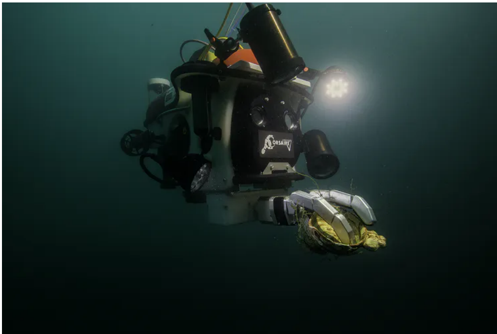
Le ROV Speedy et la main Techno Concept saisissant un objet du XVII e siècle. F. Osada, T. Seguin/DRASSM
