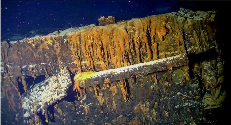
Colorées de jaune par les composés soufrés, les stalactites de métal révèlent que la carène d'acier est attaquée par des bactéries. Image capturée par le ROV.
