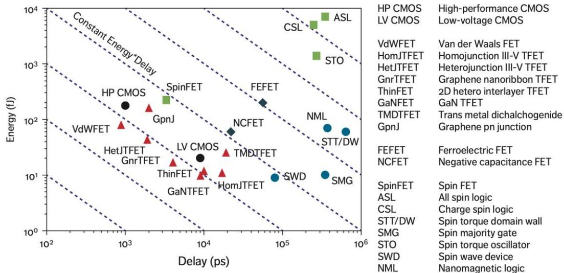
Fig. 2 : évolution des caractéristiques des dispositifs élémentaires (14).
