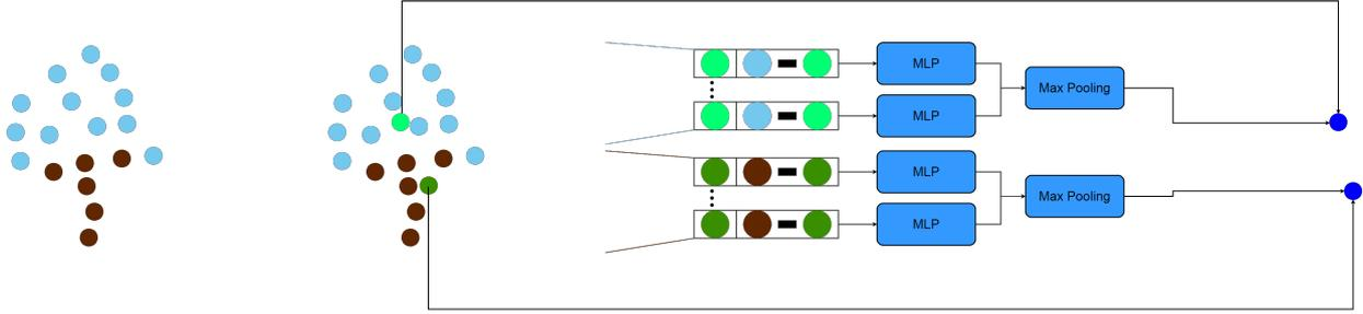
FIGURE 6 – Schéma du calcul de la couche de *graph-convolution*. Les *clusters* sont passés en entrée afin de calculer la partie géométrique du résultat, puis des perceptrons multi-couches sont suivi d’une agrégation maximale sont appliqués dans chaque *cluster* afin d’obtenir la partie caractéristique du résultat.
