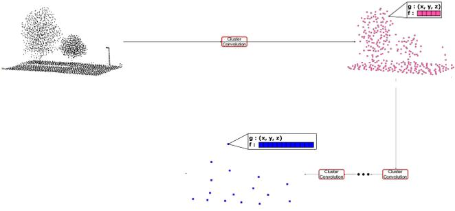
FIGURE 3 – Schéma de l’opération de *cluster-convolution* : un nuage de points est passé en entrée de celle-ci, obtenant en sortie un nuage de points de plus petite taille avec un nouveau vecteur de caractéristiques pour chaque point. Cette opération peut être appliquée successivement impliquant à chaque fois un nuage de plus petite taille avec des vecteurs de caractéristiques de dimension supérieur.
