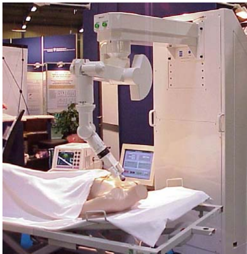
FIG. 8 - Le robot anthropomorphe Hippocrate pour le diagnostic par échographie de pathologie vasculaire
