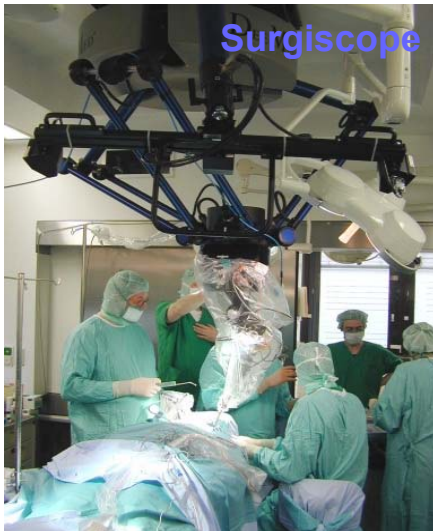
FIG. 11 - Le Surgiscope suspendu au plafond
