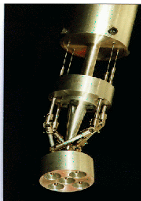
FIG. 21 - Poignet articulé de C. Reboulet pour le domaine médical, 1994
