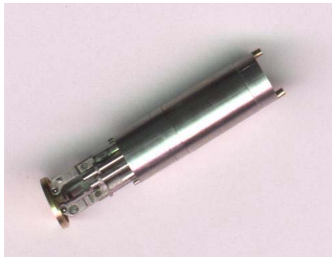
FIG. 20 - Le micro-robot chirurgical pour l'endoscopie (INRIA projet COPRIN) ; 3 ddl, 7 mm de \phi , 25 mm de long
