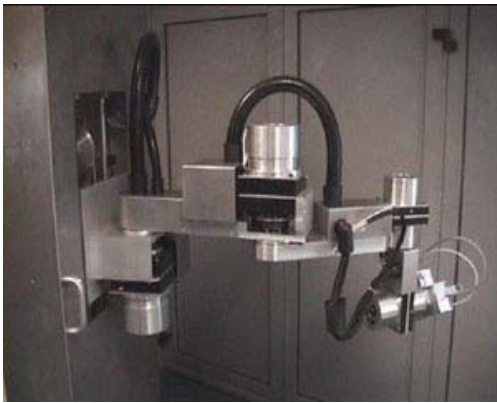
FIG. 26 - Le robot à sécurité passive PADyC (TIMC)
