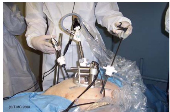
FIG. 23 - Le robot LER ( Light Endoscopic Robot , TIMC)
