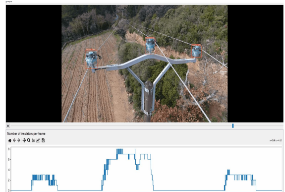
FIGURE 2 – GUI affichant les résultats de l'analyse d'un drone survolant 3 poteaux, supportant respectivement 3,7, et 3 isolateurs. Le graphe montre en abscisse la timeline de la vidéo et en ordonnée le nombre d'objets détectés.
