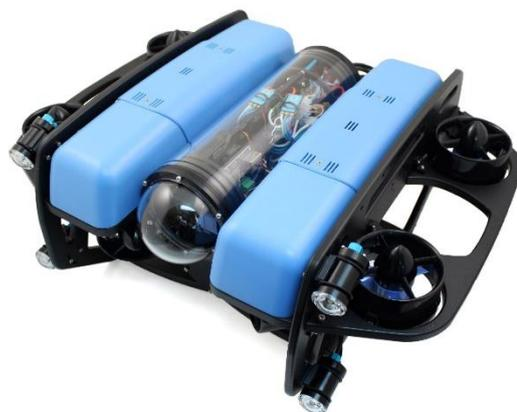
*Figure 1. Le véhicule sous-marin BlueROV2 de la société Blue Robotics, utilisé pour les séances de travaux pratiques du module « Marine Mechatronics » du master MIR. Quatre propulseurs verticaux sont placés sur les côtés du robot. Le tube central contient la carte Raspberry Pi et le reste de l'électronique (Pixhawk, modem CPL, variateurs ESC...).*
