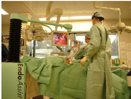
FIGURE 4.7: Commande du robot EndoAssist par le suivi de la tête.
