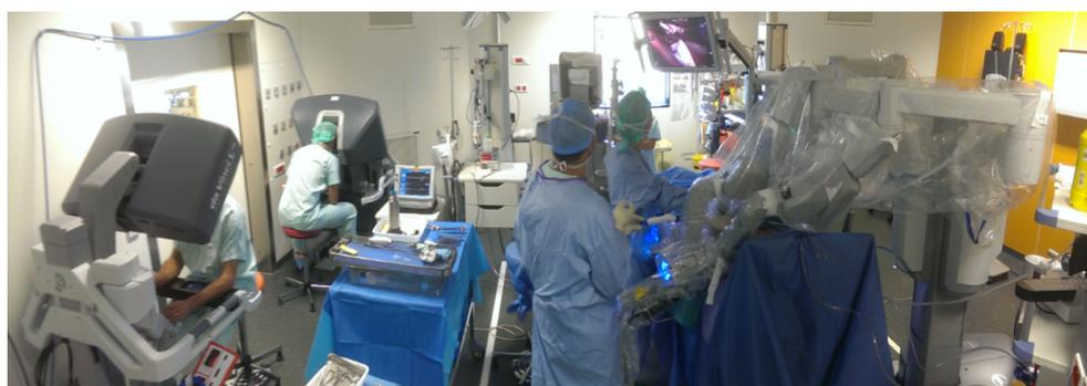
(c) Le robot da Vinci avec deux consoles au bloc opératoire.
