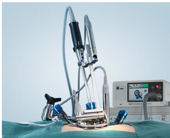
FIGURE 4.6: Robot ViKY porte endoscope contrôlé via une interface vocale. Source: Endocontrol.
