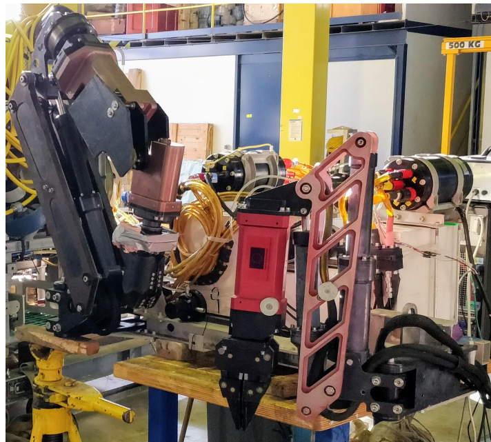
Figure 4.15 – Installation expérimentale des bras 7E (gauche) et 5E (droite) d' Ariane pour les tests de manipulation à deux bras.
