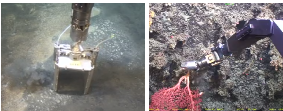
(a) Carottage en utilisant un outil dédié.
