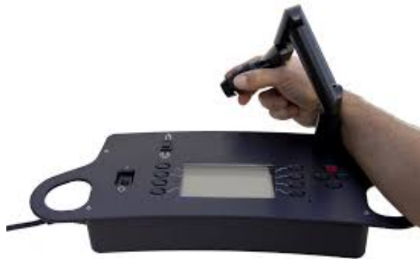
Figure 2.2 – Bras maître permettant le contrôle d'un bras en boucle fermée. Le bras maître a les mêmes proportions que le bras esclave, et on pilote ce dernier en lui appliquant les mêmes variations de position angulaire que celles mesurées par les capteurs du bras maître.
